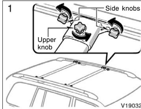
ADJUSTING THE POSITION OF CROSS RAILS:
