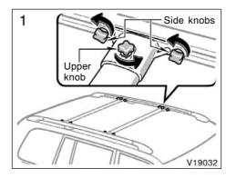
ADJUSTING THE POSITION OF CROSS RAILS:
